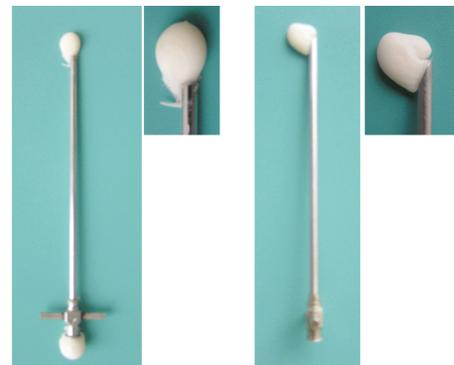
图 8 在空气中斜面穿刺针、菱形穿刺针注射骨水泥分布形态
